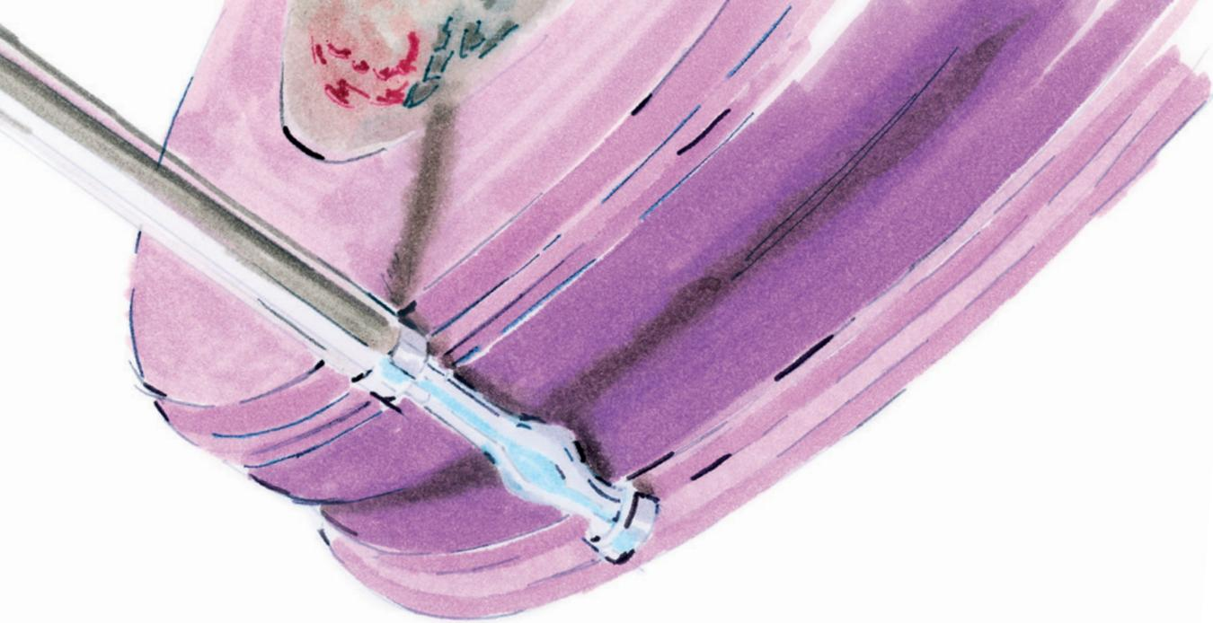
**轧辊磨削**是一种高强度的磨削工艺。不同材料与不同尺寸的轧辊通常需要匹配不同的砂轮。我们的砂轮可保证工件的表面质量始终如一。我们的陶瓷结合剂CBN砂轮对轧辊磨削工艺来说通常是一个更为经济的选择。
