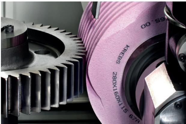
根据齿廓的加工工艺的区别，可以分为非连续性和连续性磨齿或成型磨砂轮：
