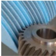
抗扭曲和有针对性地影响取决于工艺的扭曲对加工工艺提出了很高的要求。由于采用了易于操作的用户指导 以及在机器内部对修整和磨削行线进行计算,这种工艺现在也已用于批量生产。
