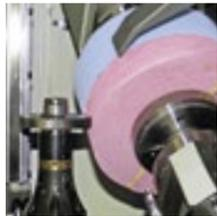
KAPP NILES 机器的精磨技术可用于成型磨削工艺中,也可用于滚动磨削工艺中。额外所需的时间一般小于传统磨削加工时间的 50%。
