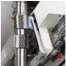
KAPP NILES 提供种类广泛的机器设计,能够磨削不同尺寸范围的人字齿部。无论是配备了水平还是垂直的工件轴,所有机器的硬件/软件都可以配备用来磨削人字齿部的创新解决方案。
