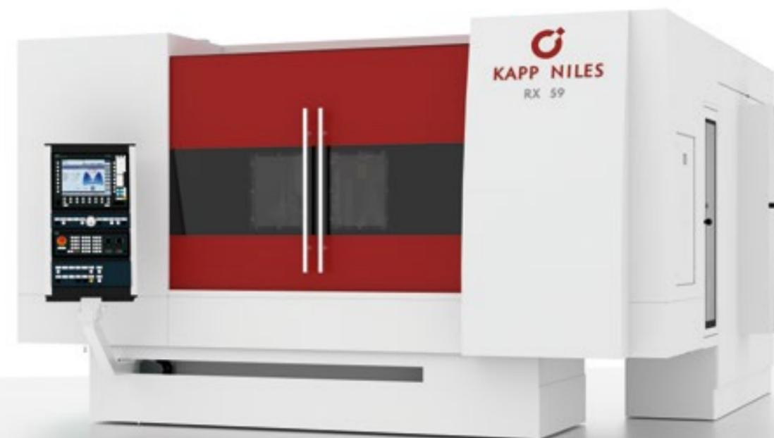
RX 系列的机器用于预磨和精磨预成型的铸铁或铸钢材质的螺杆转子。得益于刀具心轴创新的驱动设计，可达到高达 46 kW 的最大驱动功率。这样在粗磨时可达到的最大的磨削去除率，从而显著缩短加工时间。与最合适的刀具设计相结合，可确保高产量高效益的加工流程。
