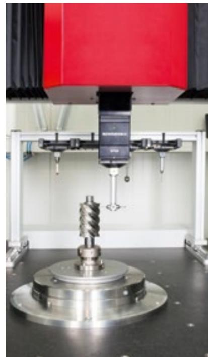
所有轴上的空气轴承导向元件可确保无磨损、平稳运行
