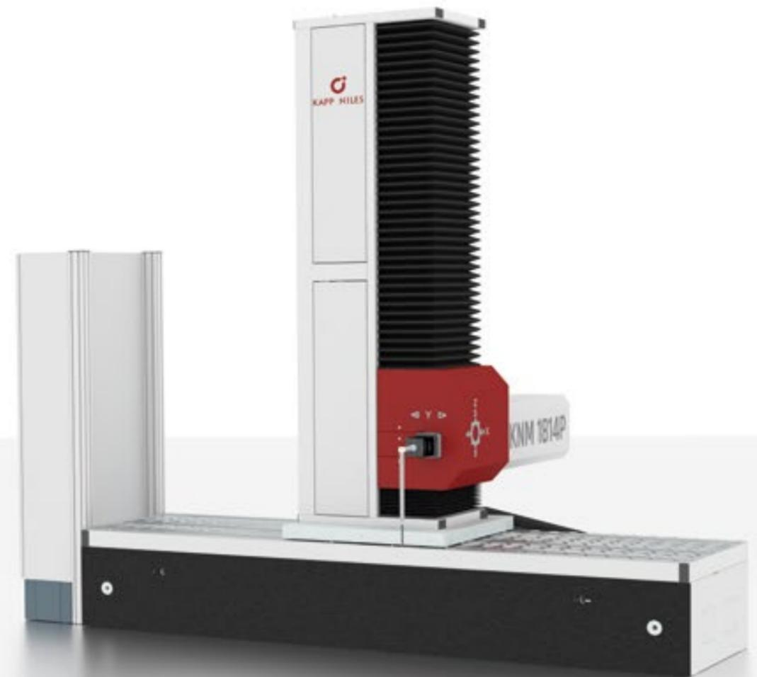
KNM P 系列的设备已根据客户对测量齿部、环形工件 (如轴承环)、外壳等的特殊要求直接在生产机器上进行了优化调整。通过结合按照客户要求设计 (扩展坞) 的底板和回转台, 产生了一个完美的 4 轴测量设备。在没有回转台的情况下也可以直接在车间中进行测量。在 KNM P 机器中还使用了特殊结构的高精度机械装置, 易于接近, 并具有最先进的驱动技术 (直线电机)。
