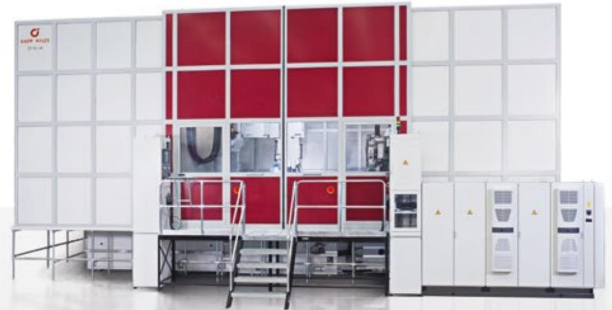
ZP B 结构的机器设计用于对外齿行星齿轮和正齿轮齿顶直径达3,000毫米进行全面的硬精加工。通过组合各种加工方法可以产生很高的节约潜力，这些潜力体现在以下效果中：
