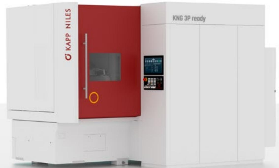
KNG 3P 型材磨床为精密加工提供了一个廉价的入口。它是为中小型批量的灵活生产而设计的。该机床的特点是，磨削主轴具有高驱动力，可加工模数达10mm的零件。直接驱动的旋转工作台尺寸宽大，工作台负荷可达350公斤。修整器固定在刀具轴上，甚至允许使用最小直径为65mm的小型修整轮。工作区域可以在大的螺旋角下无限制地使用。另外，机床的旋转范围允许磨削蠕虫。由于机床床身高度低，
